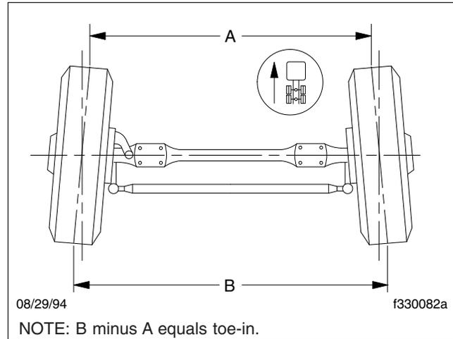
**Fig. 9, Wheel Toe-In (overhead view)**
